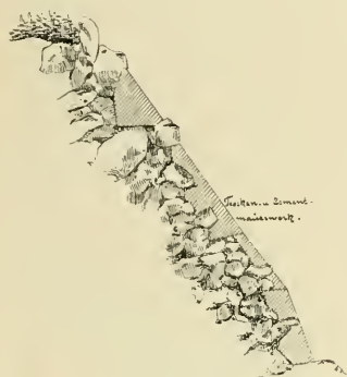
Abb. 84. Type für Steinschlag-Verbauungen. [Arlbergbahn.]
